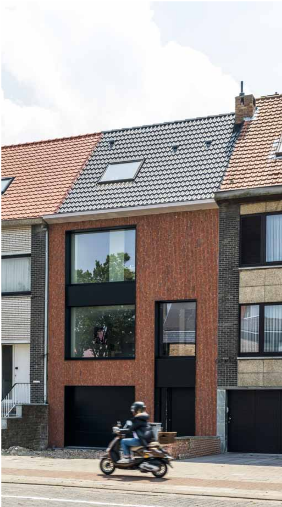
Изоляционные панели Façabrick с кирпичной плиткой Metropolis Aula Rood
